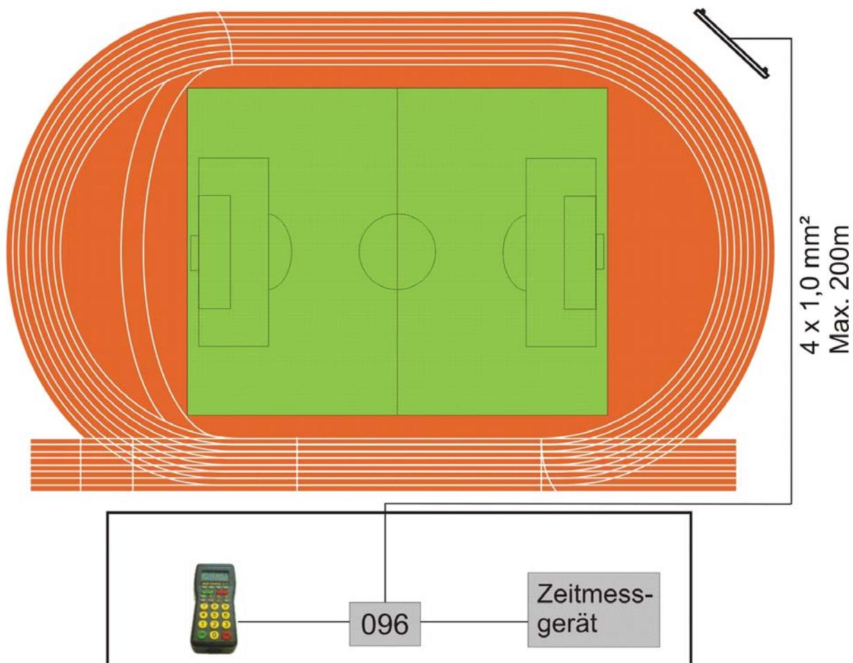
Beim Anzeigetafel Modell FL845 und FL045 besteht die Möglichkeit über ein Zeitmessgerät die Laufzeit anzuzeigen. Die Anzeige erfolgt 6-stellig in Minuten, Sekunden und 1/100.
