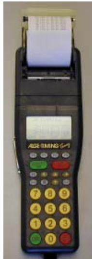
tenir le capot jaune de l'imprimante et le soulever
