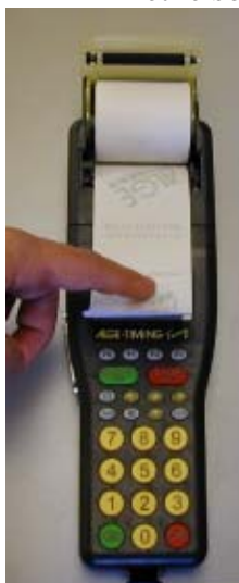
insérer le nouveau rouleau de façon à ce que le papier sorte sur le devant.
