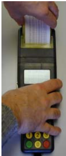
tenir le capot jaune de l'imprimante et le soulever
