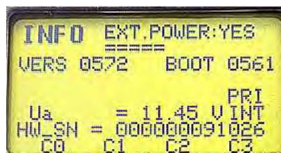
Display con alimentazione esterna
