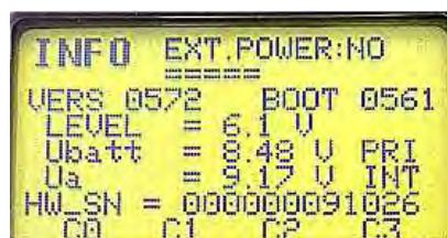
Display senza alimentazione esterna
