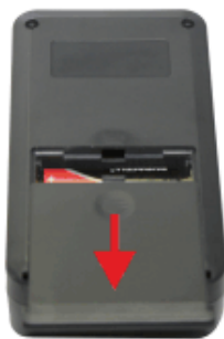
Batteriedeckel nach unten drücken und in Pfeilrichtung ziehen
