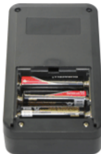
WTN mit offenem Batteriefach
