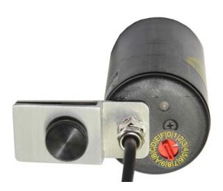
**Sendefrequenz:** 2,4 GHz Band, 16 einstellbare Frequenzen **Sendeleistung:** 10 mW bzw. 10 bis 100 mW (einstellbar)
