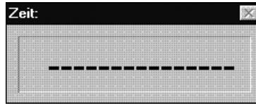
Der OPTI1sw kann sehr einfach überprüft werden, indem man einen Startschuß auf der Ziellinie aufzeichnet. Der aufgezeichnete Startschuß (Flamme) muß genau bei der Zeit 0.000 erscheinen. Ist dies der Fall, dann ist gewährleistet, daß das System rechtzeitig startet.
