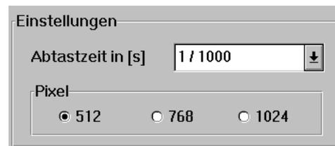
**1024 Pixel:** Hohe Auflösung, großer Speicherverbrauch, maximal 1000 Zeilen pro Sekunde Abtastzeit bei 5 m Kabellänge, minimal 700 Zeilen pro Sekunde bei 30 m Kabellänge
